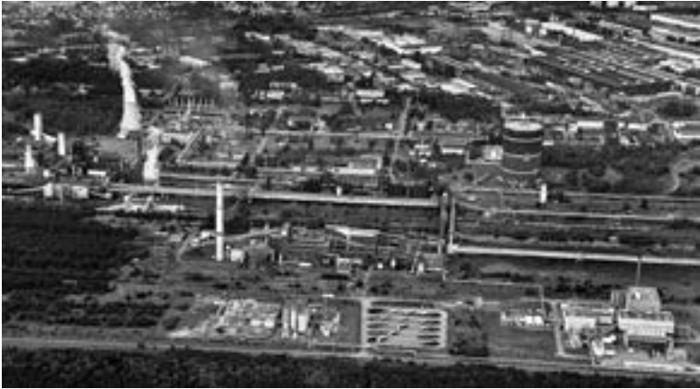
Abbildung 9: Werksgelände von ArcelorMittal Eisenhüttenstadt 2017. Im Vordergrund Sinteranlage und Hochofen. Oben rechts im Bild: Kaltwalzwerk und Teile des neuen Warmwalzwerks
