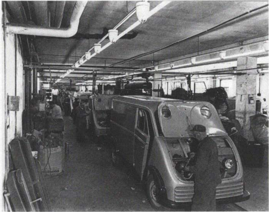
Abb. 2: Fertigung des Schnell-Lasters der Auto Union in provisorischen Werkshallen
